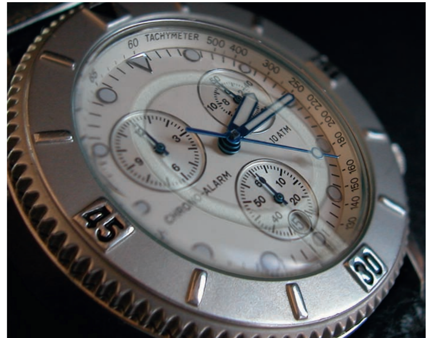
Photo d'un verre de montre avec antenne RFID transparente rendue visible. © Winwatch SA
